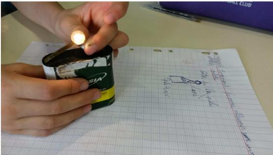
Pour allumer une ampoule sur une pile plate il faut mettre le culot sur une lame et le plot sur l'autre lame.
