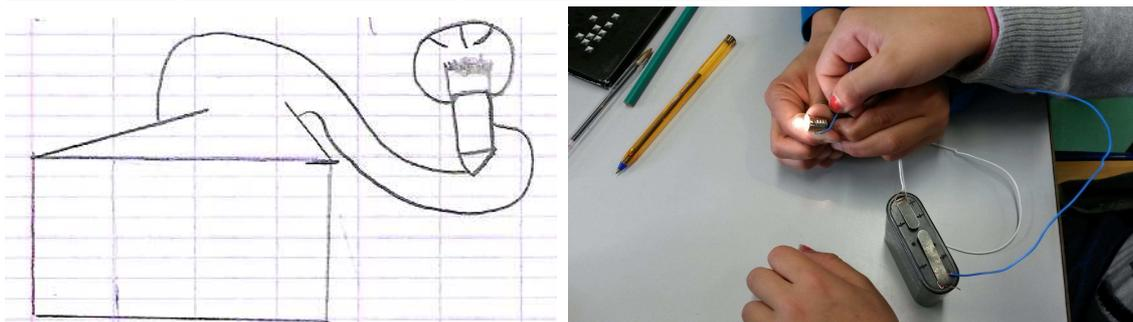
Pour allumer une ampoule avec 2 fils, il faut mettre 1 fil sur une lame et le mettre sur le plot, et pareil pour le deuxième fil mais on le met sur le culot.
