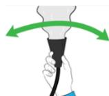
**4.** Pour neutraliser tout le combustible, déchargez l'extincteur en projetant lentement l'agent d'extinction d'un mouvement de balayage latéral au-dessus de la base des flammes. Ne se rapprocher du feu que progressivement et une fois qu'il aura diminué d'intensité.
