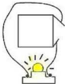
circuit électrique fermé
